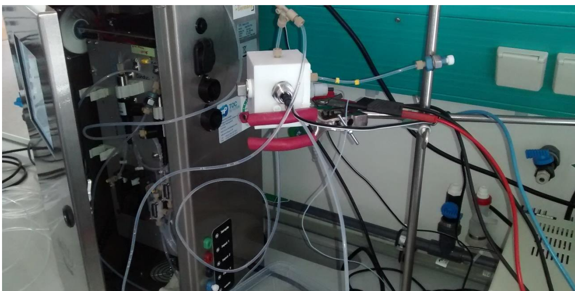
Abb. 2: TOC Sens Messsystem (weißer Kubus) bei der Vergleichsmessung mit einem Pilot miniTOC (links)
